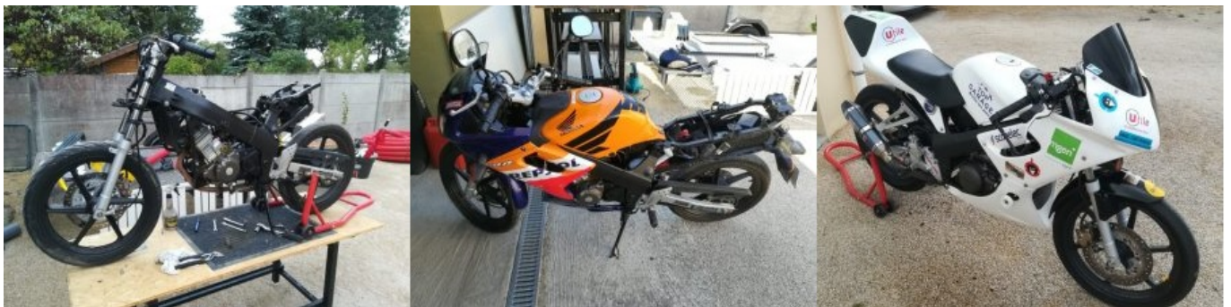
La moto de route avant la transformation pour la piste/La moto dénudée, en pleine mutation/Le prototype piste de la Triple Team, orné de ses sponsors.
