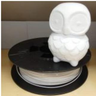
L'impression 3D consiste en la fabrication couche par couche d'une modélisation, le plus souvent en PLA : un plastique à base de féculé de pomme de terre donc 100% renouvelable. Le plastique est fondu à environ 200°C dans une buse se déplaçant sur 3 axes, avec des machines généralement à monter soi-même pour comprendre le fonctionnement du processus, étapes par étapes.
